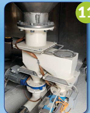
Estrazione e dosaggio in linea di trasporto Extraction and dosing on a conveyor line
