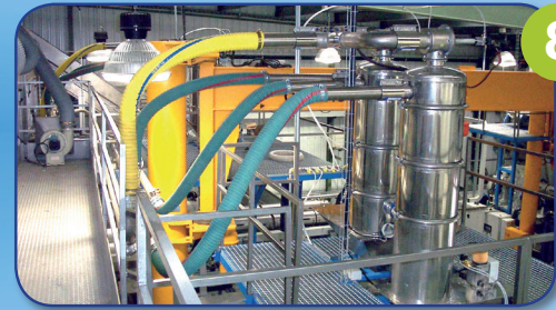
Trasporto pneumatico dei materiali Pneumatic material conveyor
