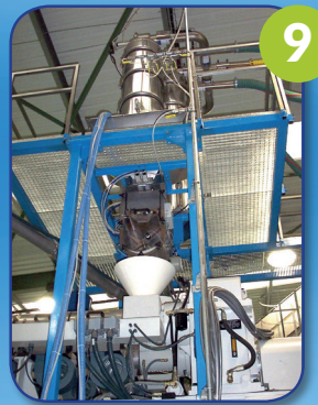
Alimentazione e dosaggio gravimetrico macchine di estrusione Gravimetric feeding and dosing of extrusion machines
